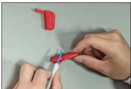
03 将金属条装上前后两端护套（护套小孔位置刚好拼接上焊锡点）
