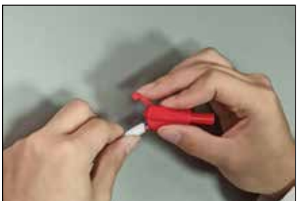
05 按压护套外壳尾端扣上盖子
